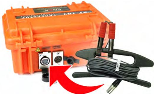
1.12.2. Один из зажимов кабеля подключается к исследуемой коммуникации, а второй к штырю заземления (или к подходящему заземлению) максимально далеко от коммуникации. Противоположный конец исследуемой коммуникации
