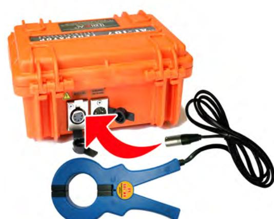
1.15.5. Затем при отсутствии генерации следует охватить клещами «выделенную» коммуникацию до полного смыкания магнитопровода клещей. Размыкание клещей и, соответственно, их переустановку на другую коммуникацию допускается производить только при отсутствии генерации.
