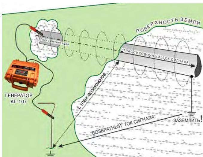
Контактный способ подключения применяется при обследовании только обесточенных коммуникаций!
