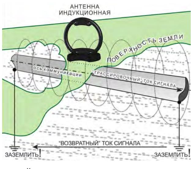
**Если используется внешняя индукционная передающая антенна «АН», то следует расположить ее как можно ближе к исследуемой коммуникации и в одной плоскости с ней.** Не следует пользоваться трассоискателем вблизи расположения передающей антенны во избежание непосредственной индукционной связи (помимо коммуникации).
