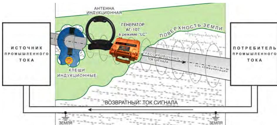
В данном примере «трассировочный» ток сигнала «высокой» частоты (0,5...33 кГц) «накладывается» на ток «низкой» (промышленной) частоты (50 / 60 Гц), что не мешает проведению трассировки, а путь протекания «возвратного» тока сигнала уже обеспечен.
